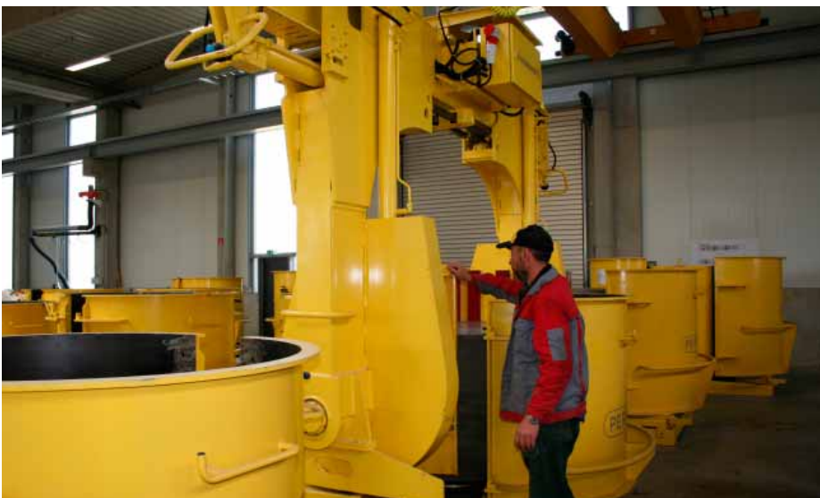
Einblick in die Schachtunterteilfertigung im Betonwerk Müller: Nach dem Aushärten wird der Betonteil aus der Schalung entnommen
