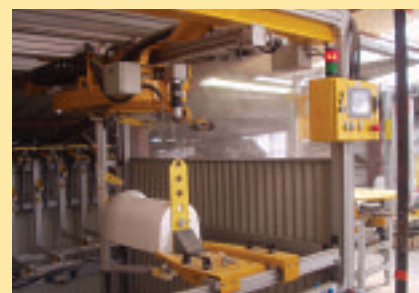
Au cœur du système PERFECT, la scie 3D : découpe tridimensionnelle sur polystyrène pour former une matrice de cunette sur mesure.
